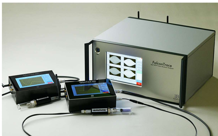
図 1 ボール SAW 技術による微量水分センサ
