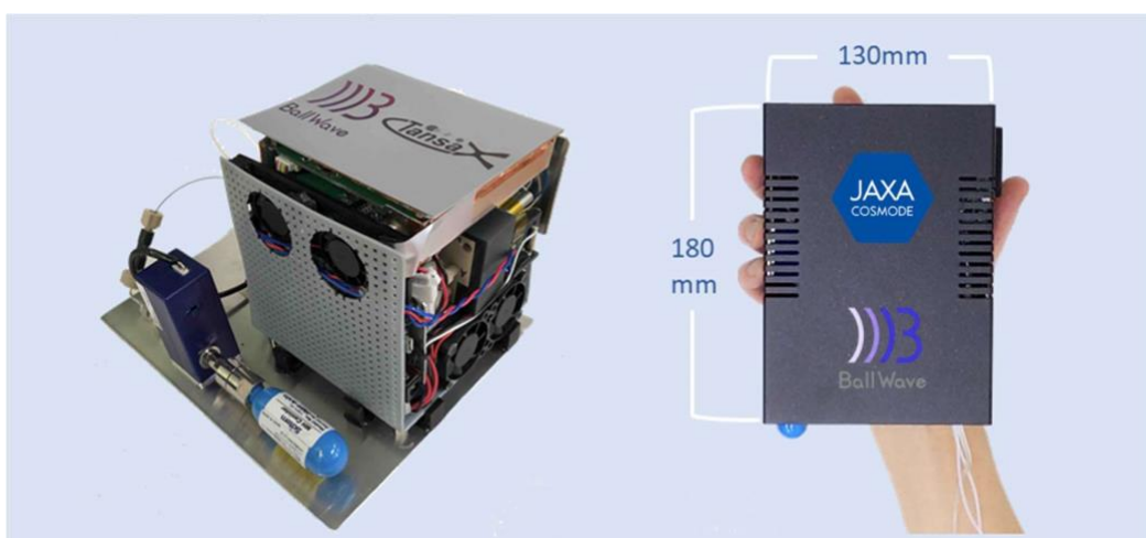
図 1 宇宙探査用途ガスクロマトグラフ（左）と地上用途ガスクロマトグラフ（右）
