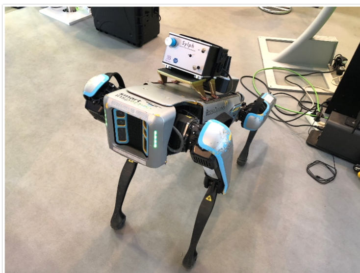
超小型ガスクロマトグラフ搭載のロボット犬
